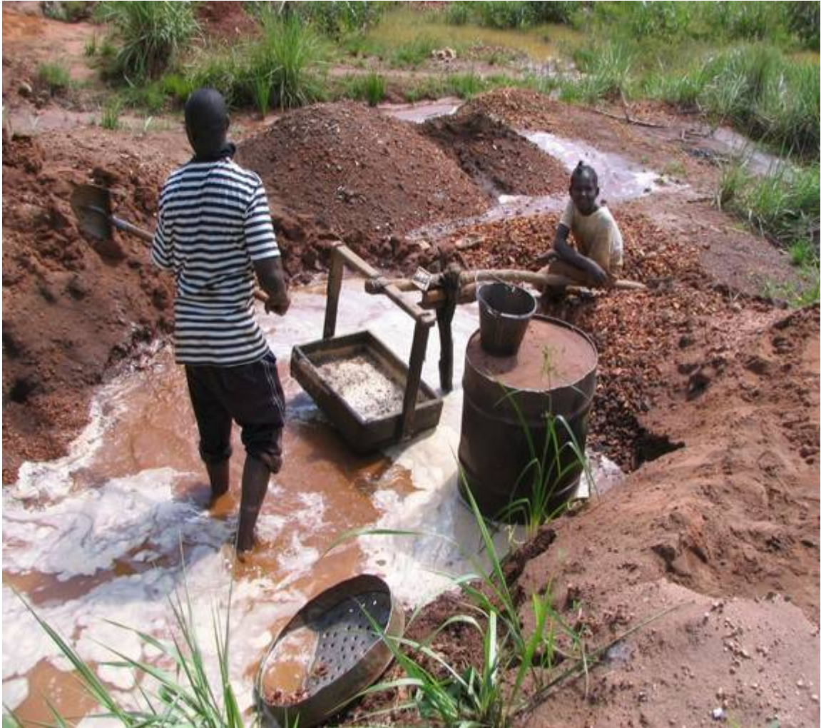
Lavage de gravier au jig à balancier en RCA.
